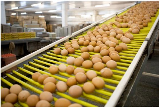
I requisiti di manutenzione sono strettamente correlati alla posizione dei sistemi di codifica ed alle procedure di pulizia. La codifica delle uova in linea, a valle dell'area di trasferimento, è probabilmente l'area più impegnativa in quanto le selezionatrici spesso espellono le uova in questo punto, a volte le uova scivolano fuori dalle pinze e le uova rotte gocciolano. È importante stabilire procedure
