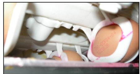
umidità o per un apparecchio di asciugatura inefficiente, installare una lama d'aria che asciughi la superficie delle uova dove verrà stampato il codice. Regolare la pressione dell'aria dalla lama al fine di ottenere un'asciugatura ottimale senza danneggiare l'uovo: una pressione eccessiva dell'aria può rompere un uovo provocando una perdita che verrà trasportata lungo il sistema di imballaggio.
